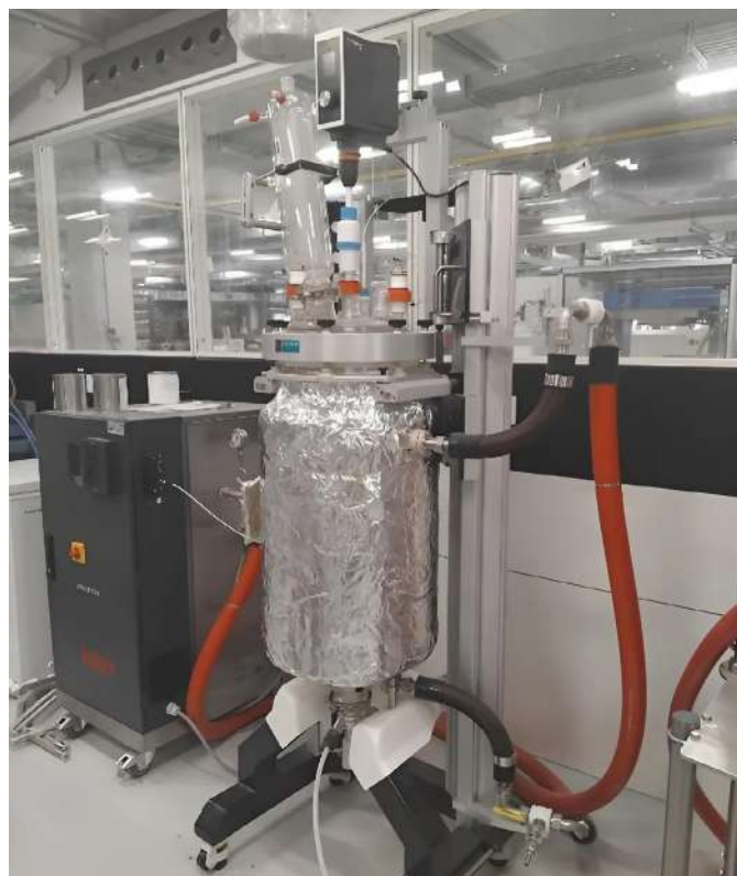
Figura 3. Reactor de despolimerización
