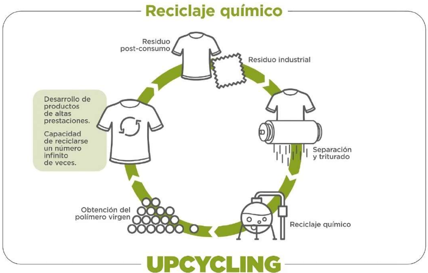
Figura 1. Ciclo de vida de los residuos textiles post-consumo haciendo uso del reciclaje químico para implementar una economía circular.
